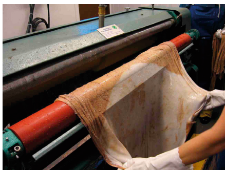
Одна стороны шкуры уже отскоблена на машине, и кожа перевернута для обработки другой стороны.
