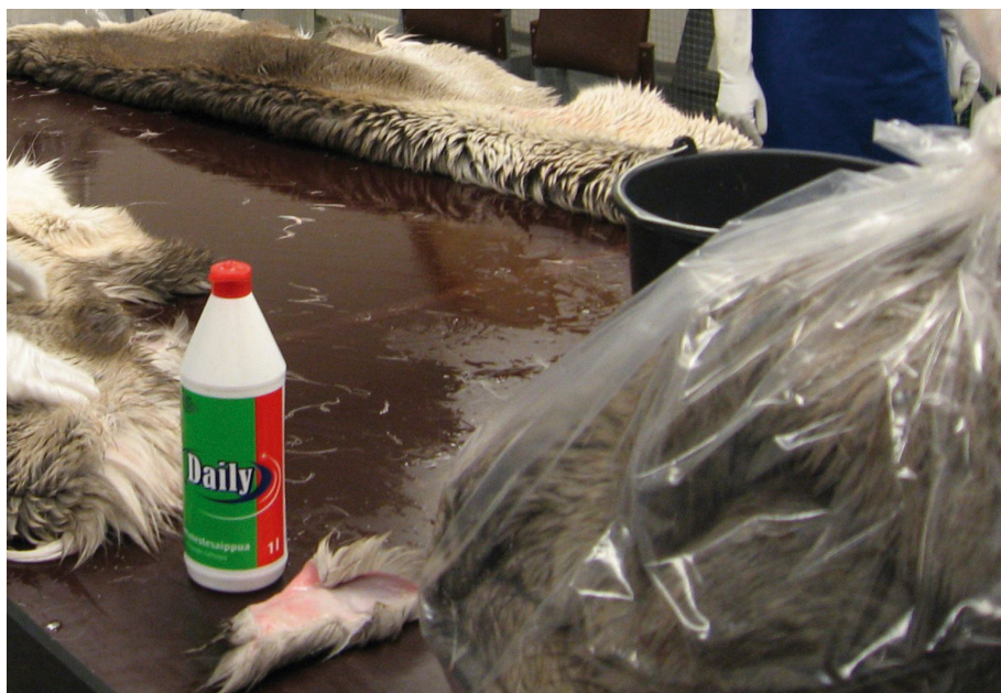
Обезволашивание. Шкуры после промывки укладывают в пластиковые пакеты.
