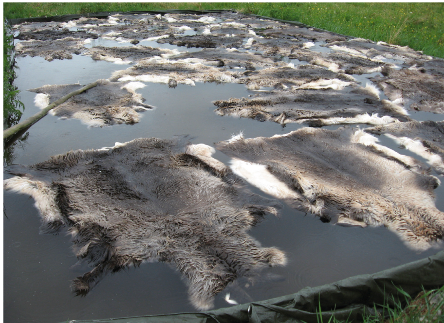
Процесс удаления шерсти в водоёме, Jokkmokks Naturskinn (Йокмокк, Швеция).
